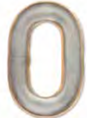
Längsschliff eines Kettengliedes in der Qualität KU 350E14 (Aufkohlungstiefe E14=0,14 \times d ) Longitudinal Grinding of a Chain Link of Quality Type KU 350E14 (Carburizing Depth E14 = 0.14 \times d )
