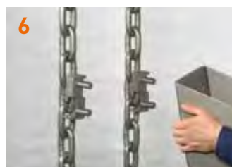
6 dann den Elevatorbecher and then the elevator bucket
