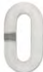
Längsschliff eines ungehärteten Kettengliedes Longitudinal Grinding of an Unhardened Chain Link
